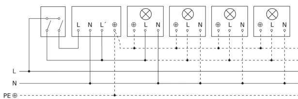
Schema elettrico Collegamento tramite un commutatore per il funzionamento continuo e automatico
